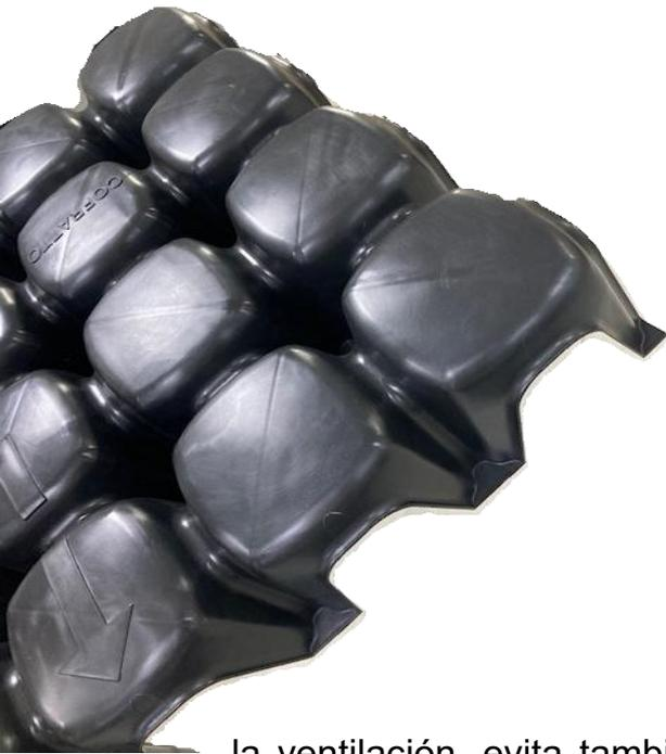
Se coloca generalmente sobre un fondo de hormigón magro de grosor variable según la aplicación. Tras la instalación de una rejilla electrosoldada adecuada, durante el proceso de hormigonado se forman pilares que, una vez madurado el hormigón, determinan la resistencia efectiva del pavimento, con la distribución de las cargas de forma homogénea sobre toda la superficie.
